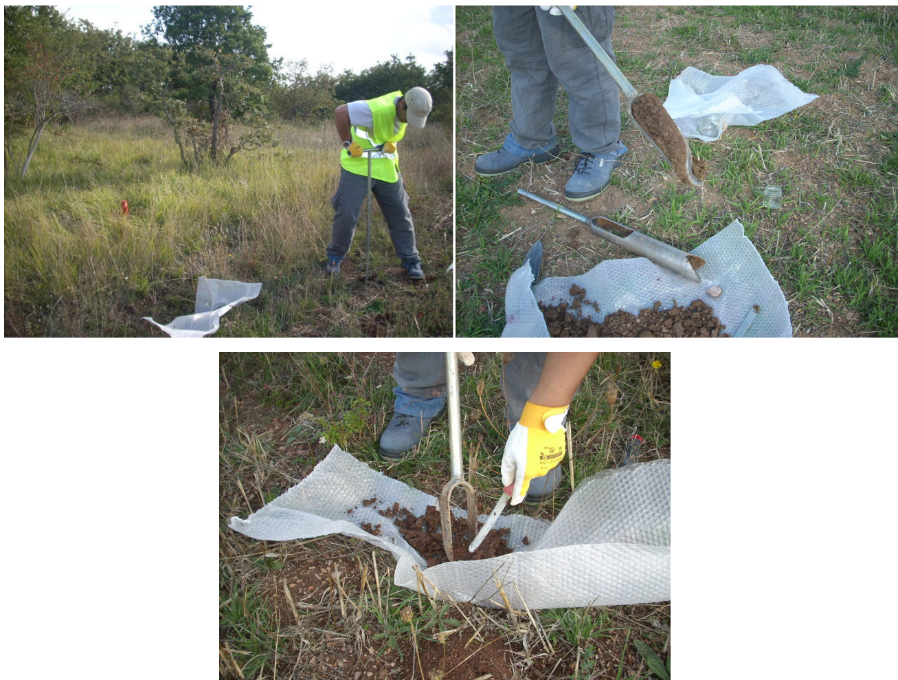
Figura 8.1-2: attività di campionamento tipo effettuate da AECOM mediante trivella manuale
